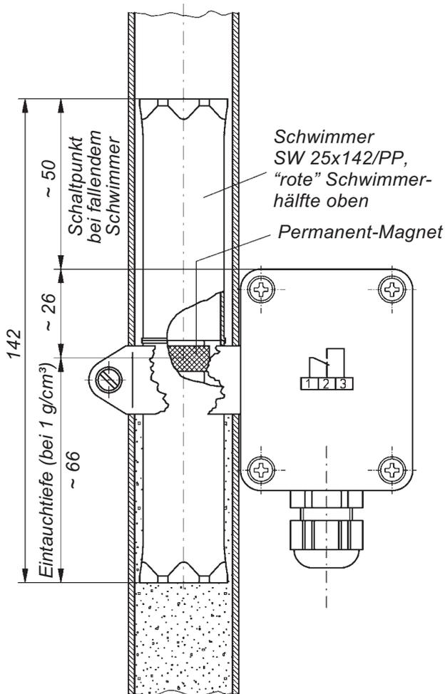
Darstellung des Schaltpunktes und der Schalterstellung nach der Bewegung des Schwimmers von "unten" nach "oben" am Magnetschalter vorbei
