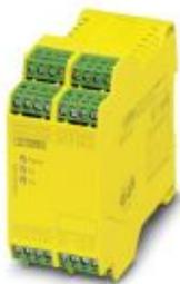
Relé de seguridad para la vigilancia de la parada de emergencia y la puerta de protección hasta SIL 3 o cat. 4, PL e según EN ISO 13849, servicio de uno o dos canales, 8 circuitos de disparo,  $U_s = 24 \text{ V AC/DC}$ , borne de tornillo enchufable
