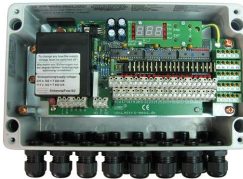
Gehäuse ALU, 260x160x90 mm, IP65, für den Einsatz in Ex-Zone 22
