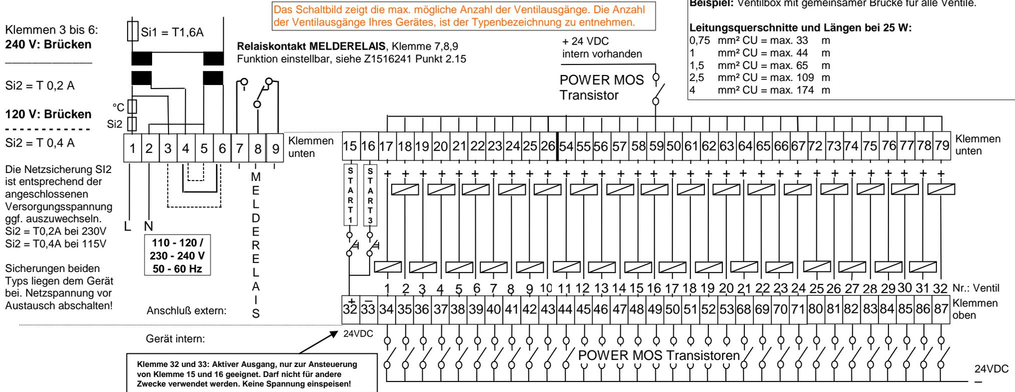
**START1 - Schalter (extern) geschlossen:** Abreinigung mit IMPULS 1 und INTERVAL 1
